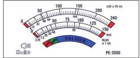
Das analoge Instrument verfügt über 3 Skalen: 2 Messskalen und 1 Skala mit Farbbereichen.
