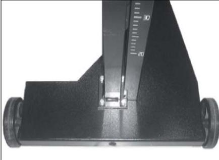
Die Säule wie abgebildet am Gerätefuß einsetzen. Mit dem mitgelieferten Material befestigen (Schraube M 8 x 20, Unterlegscheibe  $\varnothing$  8 mm, Mutter M 8)
