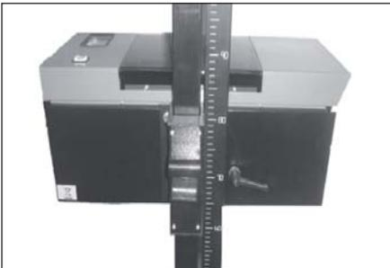
Den Optikkasten wie abgebildet ansetzen. Links oben mit der Unterlegscheibe  $\varnothing$  8 mm und der Schraube M 8 x 20 und rechts unten mit der Unterlegscheibe 8 x 24 sowie dem einrasthebel M 8 x 20 befestigen.
